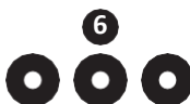
6 Prises audio-vidéo analogiques cinch, jaune vidéo, blanc audio gauche, rouge audio droit (CVBS/Audio L/AudioR) (R+L) pour haut parleurs internes et externes x 1*
